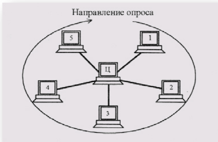
Рис. 3.5 Централизованный метод управления обменом в сети с топологией «звезда»
