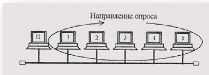
Рис. 3.6 Централизованное управление в сети с топологией «шина»
