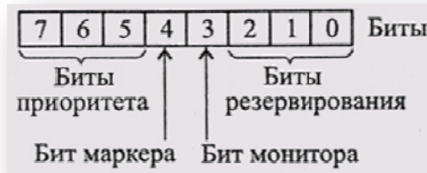
Рис. 5.9 Формат байта управления доступом
